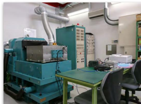
精密二軸振動試験装置
