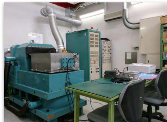
精密二軸振動試験装置
